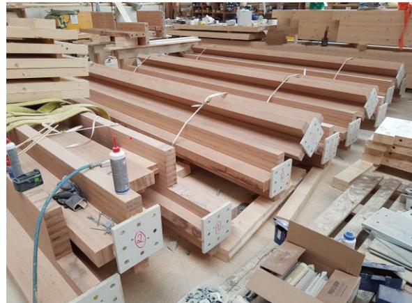
Piliers cruciformes (en hêtre) permettant l'encastrement en toiture
